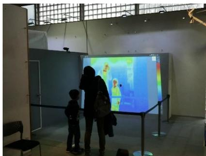
本展示物では、人物から放出された赤外線を対面に置いたカメラがとらえ、その分析画像をカメラの前面に配したスクリーンにプロジェクターで投影しています。右側にある温度ゲージには、カメラがとらえている最高と最低の温度が表示され、その温度差を白から紫までの色で均等割にして表示しています。めがねをかけた部分は、赤外線がめがねによって遮断されるため、表示色が替わります。
