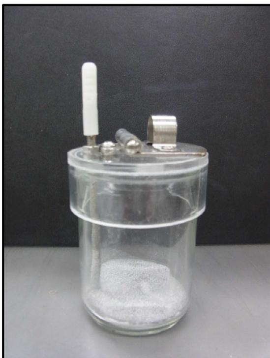
実験装置の試作を行う際に注意した点は、アルミニウムの粉末が飛び散らないか、温度上昇が正確に測定できるか、攪拌が抵抗なくできるか、容器の耐久性（熱やアルカリに対し）である。
