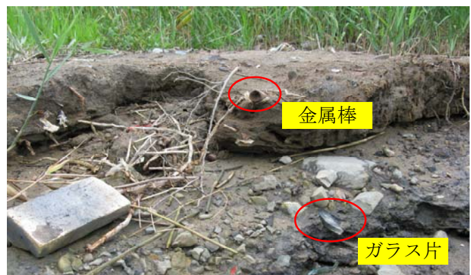
Fig.4 上部層には金属棒を含み、下部層には厚めのガラス片を含む
