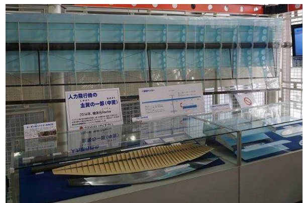
機体各部のつくり（主翼・プロペラ）
